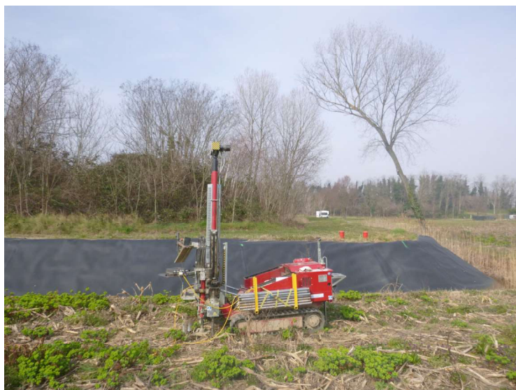
Esecuzione della prova CPTU4
