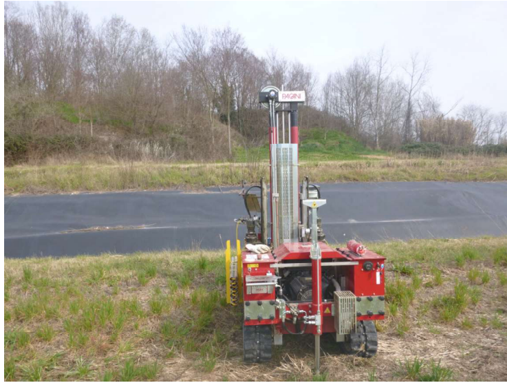
Esecuzione della prova CPTU2
