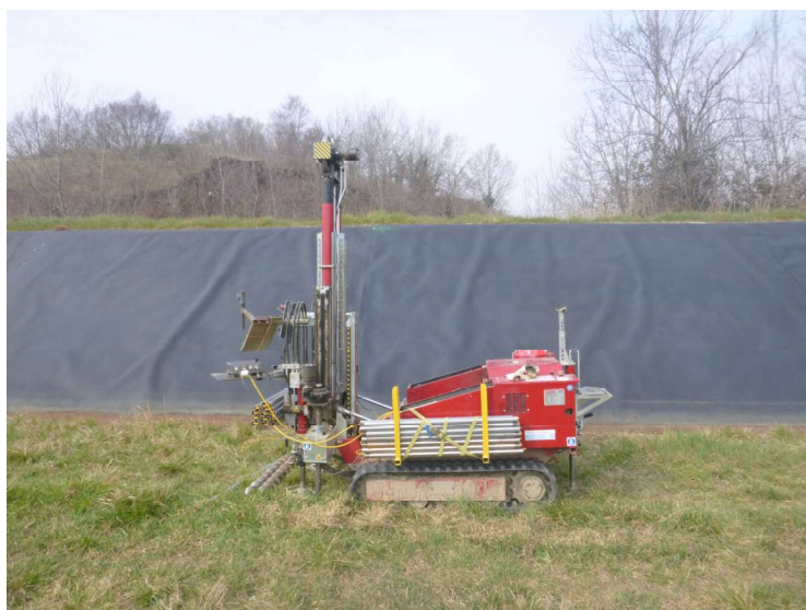
Esecuzione della prova CPTU5
