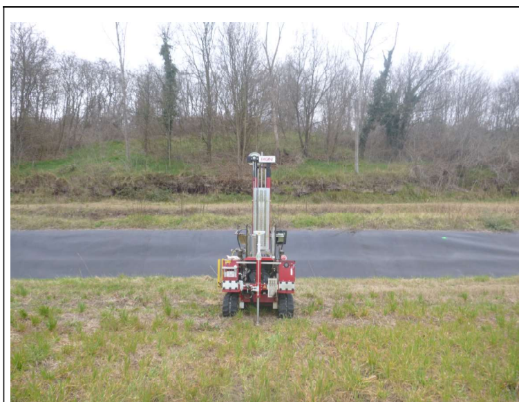
Esecuzione della prova CPTU1
