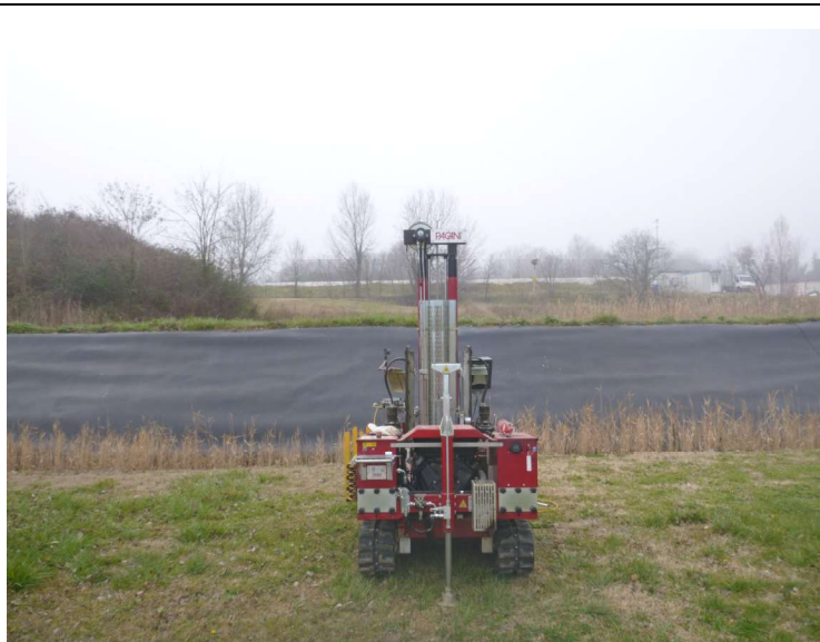
Esecuzione della prova CPTU3
